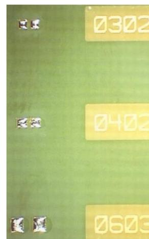
Die Lotpaste ISO-Cream® "EL 5510"- BLEIFREI ist unempfindlich gegenüber Luftfeuchtigkeit und Temperatur. Sie zeigt keine Tendenzen zur Bildung von Lotkugeln an Chip-Widerständen und Kondensatoren.
