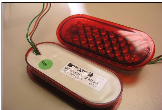
Vergussmassen können als 1K oder 2K Werkstoffe mit kondensationsvernetzenden oder additionsvernetzenden Aushärtmechanismen geliefert werden. Weitere Einzelheiten entnehmen Sie dem Produktdatenblatt über CHT Vergussmassen.
